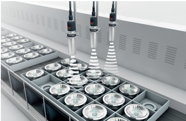
Durante il trasporto vengono controllati presenza, posizione e completezza dei componenti.
