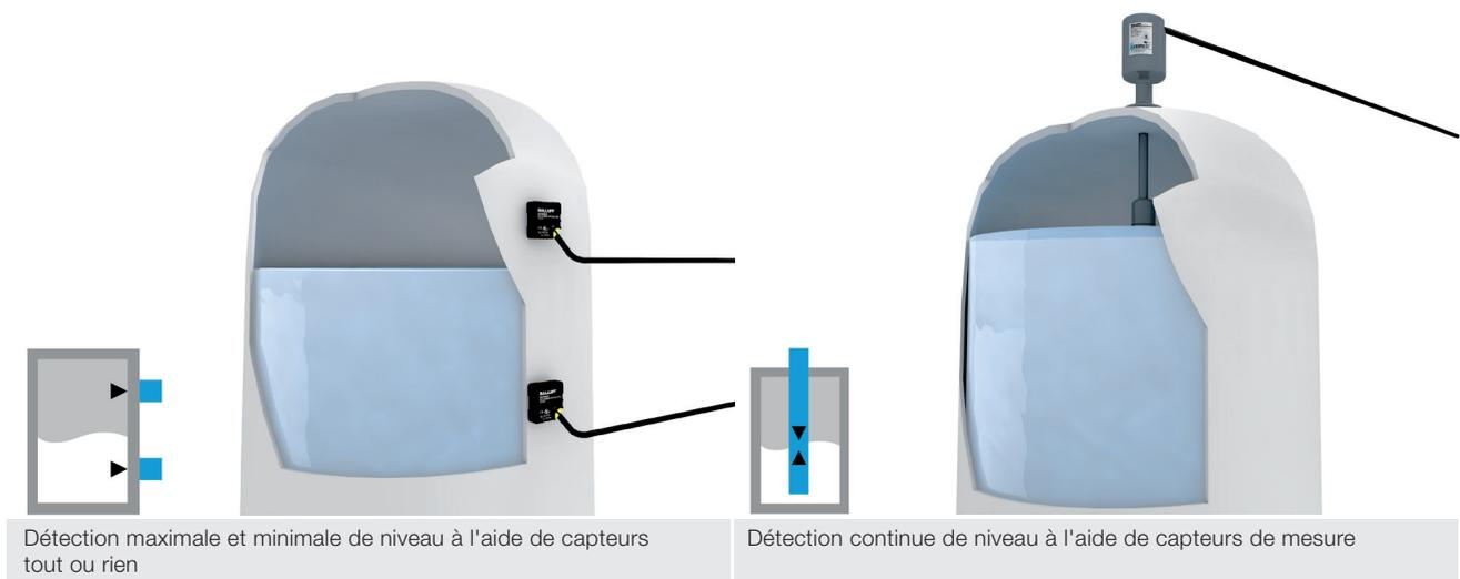
Dans certaines applications, la détection de deux positions est suffisante : le point initial et le point final. Dans d'autres applications, la détection de position est importante sur la totalité du tronçon de mesure. Selon les informations dont vous avez besoin, vous choisirez des capteurs tout ou rien ou des capteurs de mesure. Lors de la sélection, il convient de tenir compte des critères suivants :
