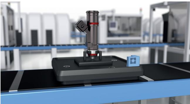
Tag RFID fixé sur un porte-pièces, qui contient les données relatives à la procédure de montage pour la pièce
