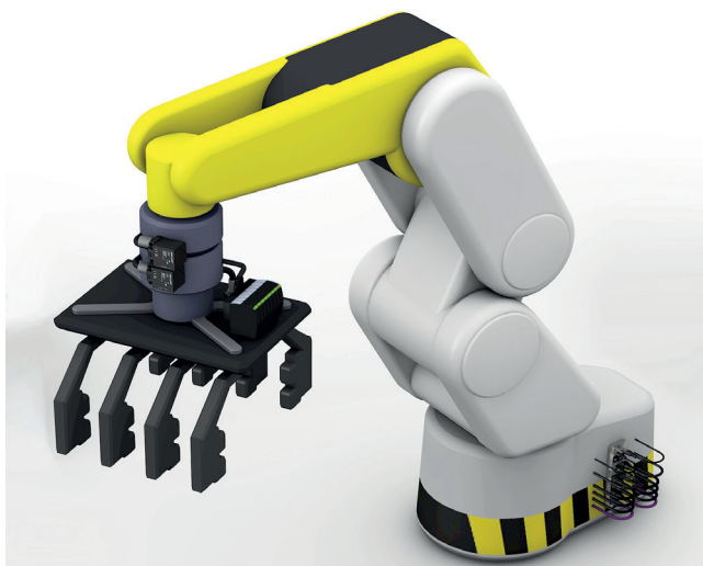
Transmisión de señales sin contacto entre la pinza y el brazo robótico
