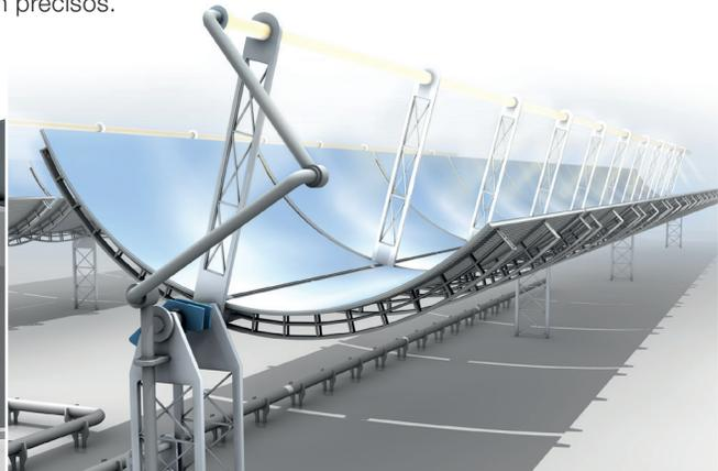
Medición de la posición de concentradores parabólicos con sensores de inclinación para el aprovechamiento óptimo de la energía solar
