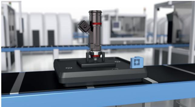
Tag RFID fijada a un portaobjetos, la cual contiene los datos sobre el proceso de ensamble para la pieza de trabajo
