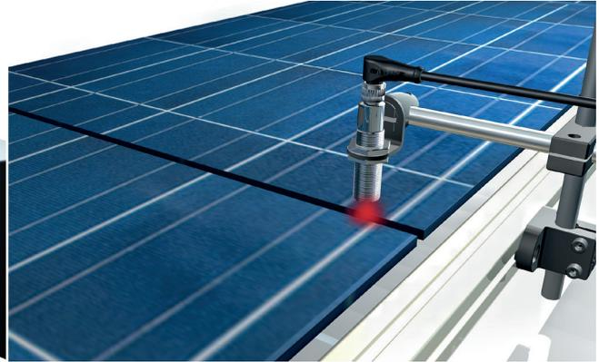
Los sensores fotoeléctricos detectan celdas fotovoltaicas sin contacto en el proceso de producción.
