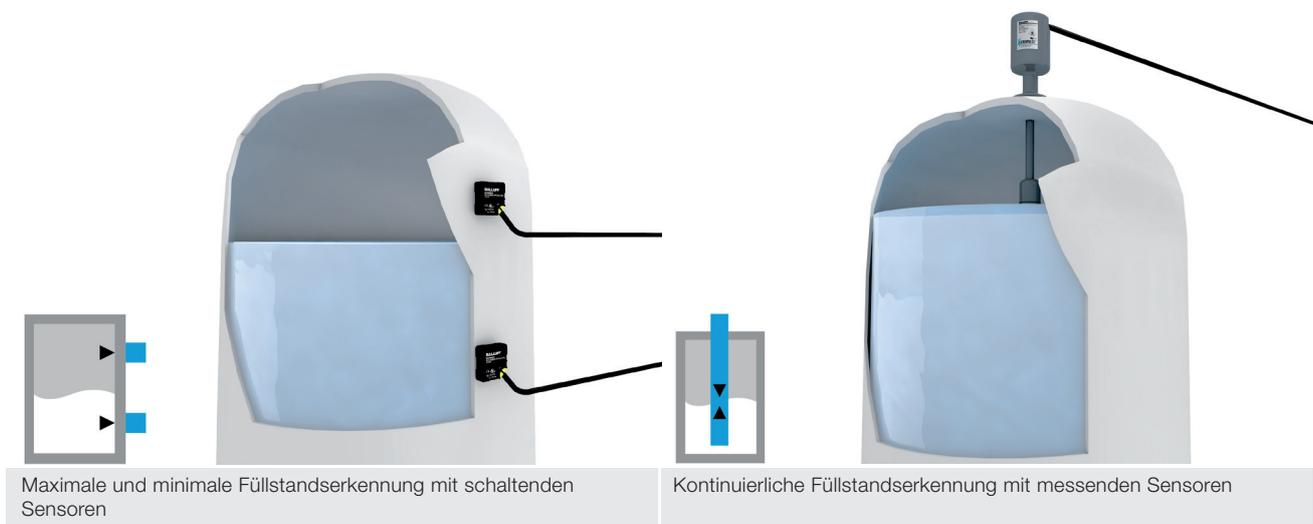
In einigen Anwendungen genügt es, wenn Sie zwei Positionen erfassen: den Start- und den Endpunkt. In anderen ist die Positionserfassung über die gesamte Messstrecke wichtig. Je nachdem, welche Informationen Sie benötigen, wählen Sie schaltende oder messende Sensoren. Bei der Auswahl sollten Sie folgende Kriterien berücksichtigen:
